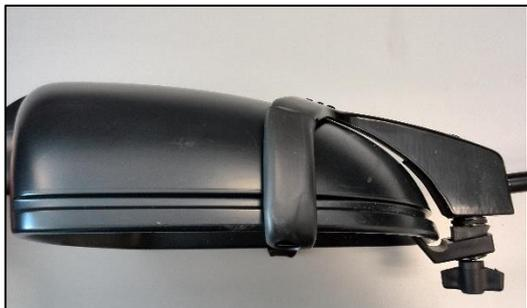
Es sollte nicht der Versuch unternommen werden, durch Kippen des Halters den Spalt zu beseitigen. Dadurch lösen sich die Halter wieder vom Seitenspiegel. Daher bitte wie auf dem Foto den Spalt lassen.
